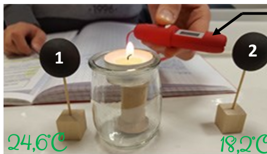
Relevé de la température de surface
